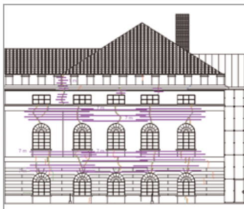
Вид восточного фасада со спиральными анкерами
