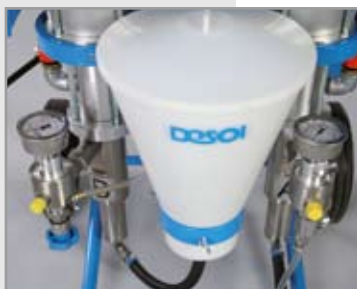
Манометр на выходе машины
